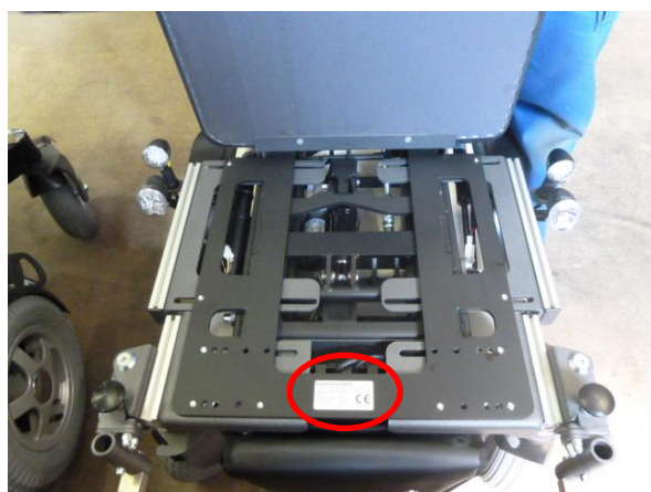
Rótulo sob a placa do assento
